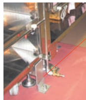
写真: 修復後の飼育装置。損傷した床面を補修し、固定具を取り付けた。
