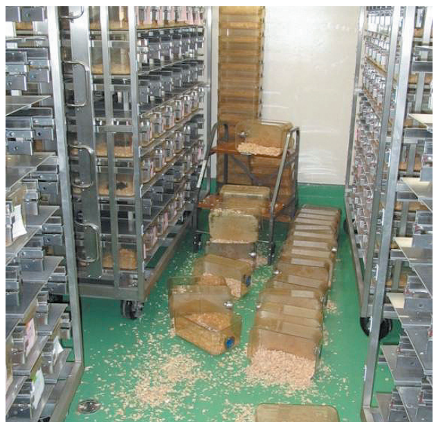
（中央棟）予備ケージは転倒したが、殆どの飼育棚は転倒せず、ケージの落下もない
